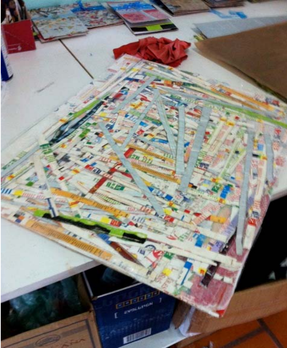
FOTO 1: placa realizada con base de tetra brik entero y terminación de refile obtenido al abrir las cajas
